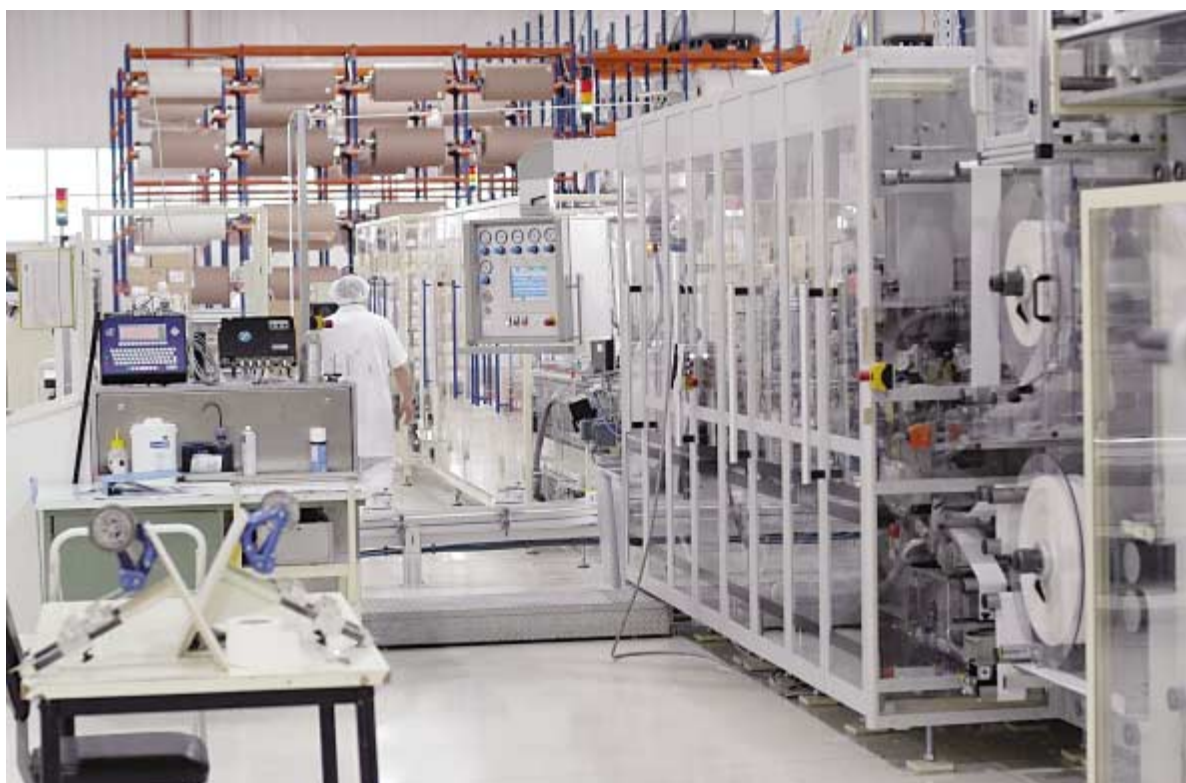
Hihg-Speed-Maschine zur Herstellung und Qualitätskontrolle von „Cosmopor“, einem selbsthaftenden Wundverband. Bei Differenzen werden die Angaben via PC abgeglichen.
